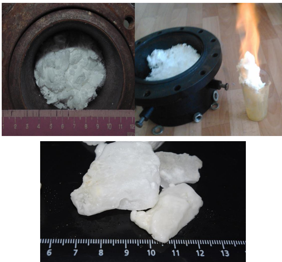
Рис.3. Синтетические гидраты природного газа со снего- и льдоподобной структурами; горение синтетических гидратов природного газа; размер кристаллогидратов от 1 до 3-6 см
